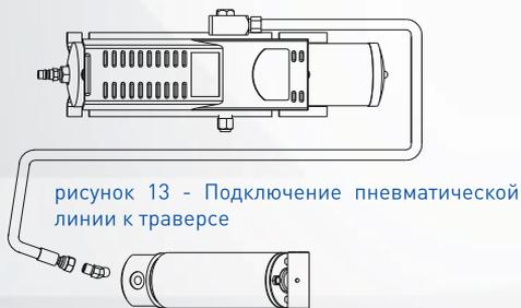
рисунок 13 - Подключение пневматической линии к траверсе
